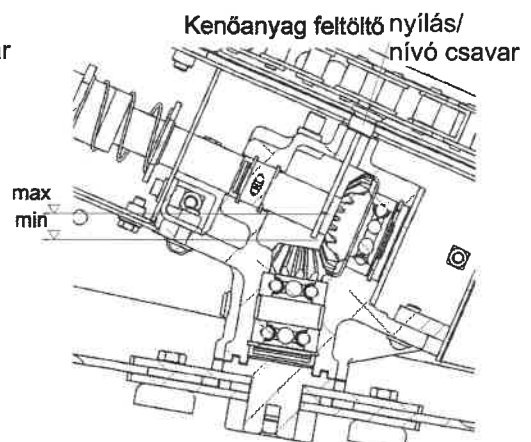
Zúzó hajtómű olajsint ellenőrzése
